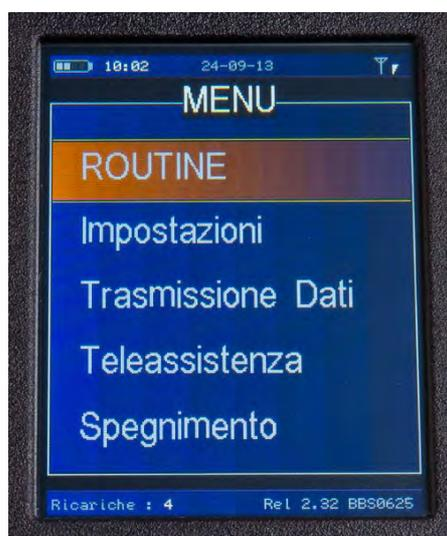
*All'accensione il palmare controlla il funzionamento del modem e della SIM all'interno del dispositivo: qualora tale funzionamento non sia corretto l'icona appare barrata e il display dà indicazione sul mal funzionamento (l'esempio illustrato riguarda la scheda SIM).*
